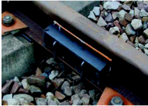
Exemples d'absorbeurs sur rail (Corus et Socitec)
