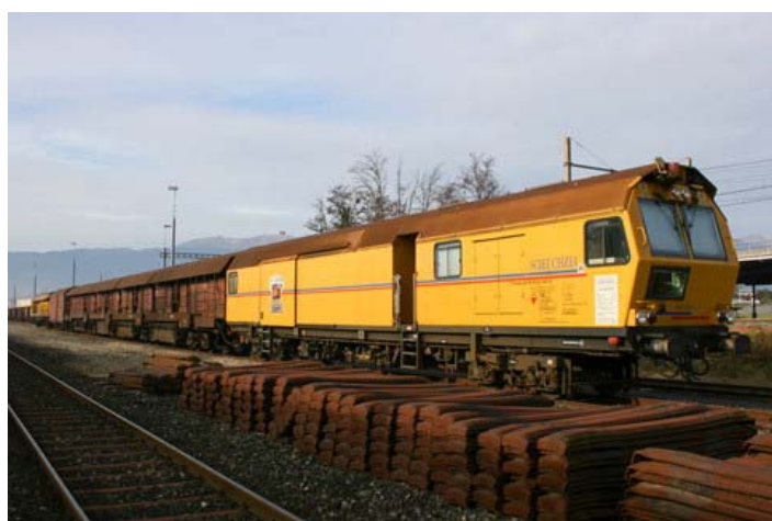
Train meuleur de rails (Scheuchzer S.A.)
